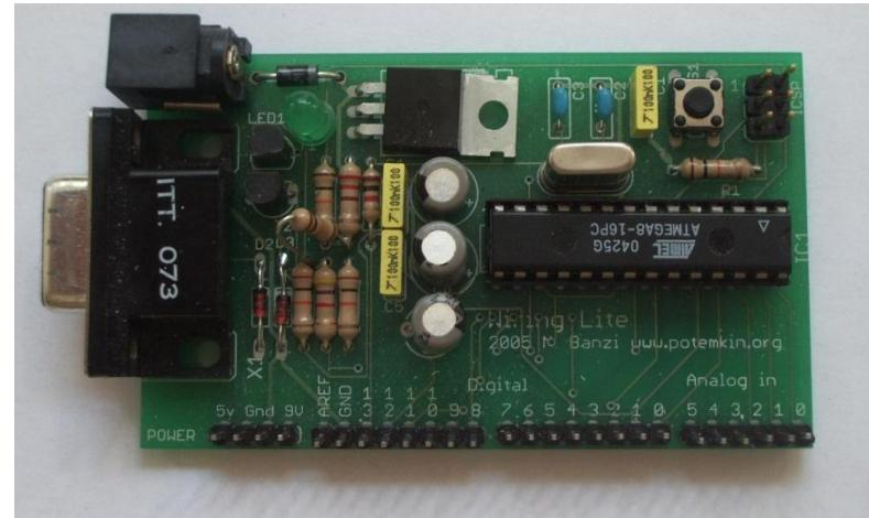
Wiring Lite – první prototyp Arduina
